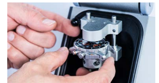
最終検査の一部：耐水性チェック Part of the final inspection: the water resistance check
