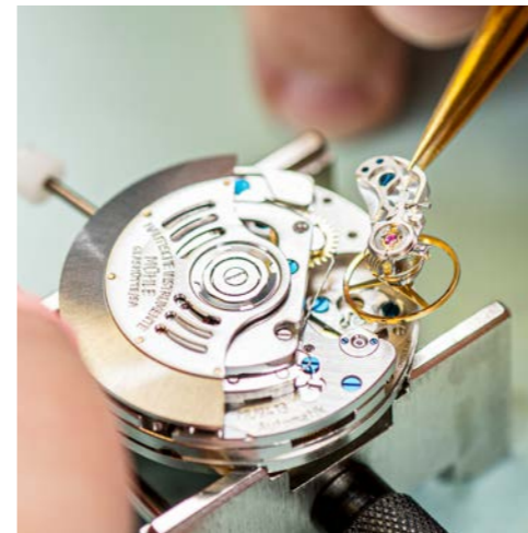
ユニークな組み立て：特別な形状のミュール バランス コックにウッドペッカー ネック調整機構を取り付けました / A unique assembly: the woodpecker neck regulation on the special-ly shaped Mühle balance cock.
